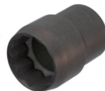
Chave soquete estriado de 36mm com encaixe de 3/4 para a porca do cubo dianteiro do Polo
